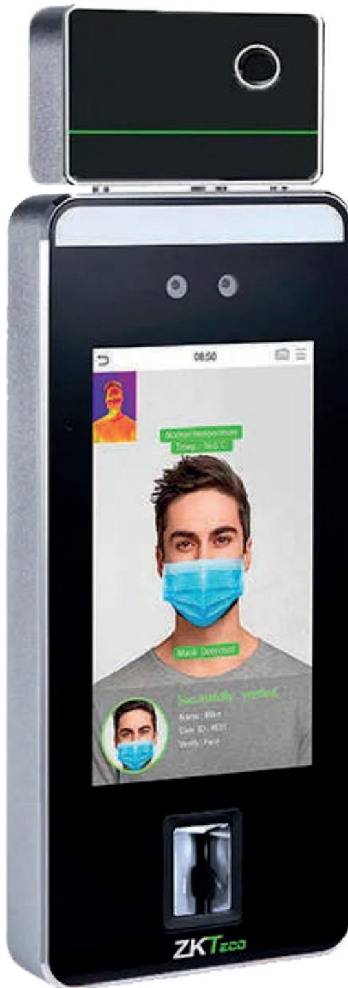
Huella con Medición de Temperatura y Detección de Cubrebocas
